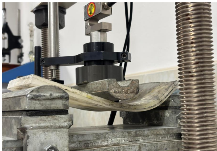
Figura 46. Ensayo de compresión falla.
