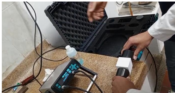
Figura 17 Prueba de cubo 5*5*5 PLA – medidor servo-controlado
