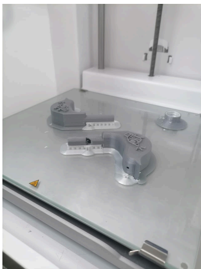
Figura 35. Silbatos imprimiendo en la impresora 3D
