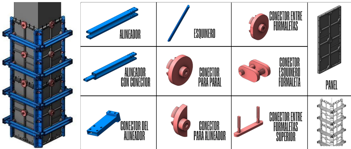
Ilustración 19. ENSAMBLAJE FORMALETA. ELABORACIÓN PROPIA
