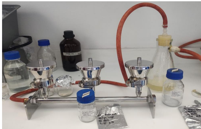
Figura 6. Sistema con embudo de filtración por membrana al vacío.
