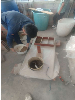
Ilustración 68. Verter la mezcla en el molde y apisonar cada capa
