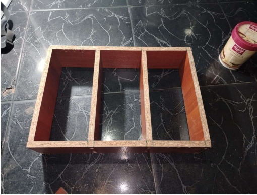
Ilustración 22. Construcción de los moldes
