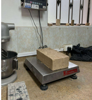
Ilustración 36. Se pesan las tres muestras, cada una con un porcentaje diferente de fibras
