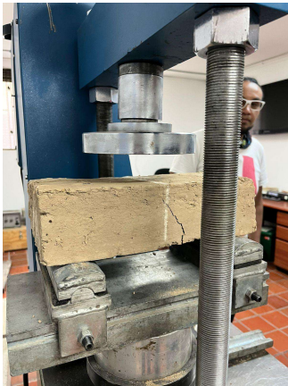
Ilustración 39. Fallo a prueba de flexión
