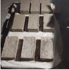
Ilustración 34. Desmolde de los bloques, se organizan para el secado
