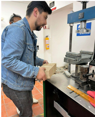
Ilustración 37. Se alistan los bloques para la prueba de flexión
