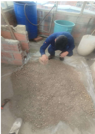
Ilustración 62. Triturar la arcilla después del secado
