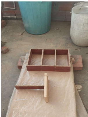
Ilustración 67. Preparación del molde y superficie para un desmolde fácil
