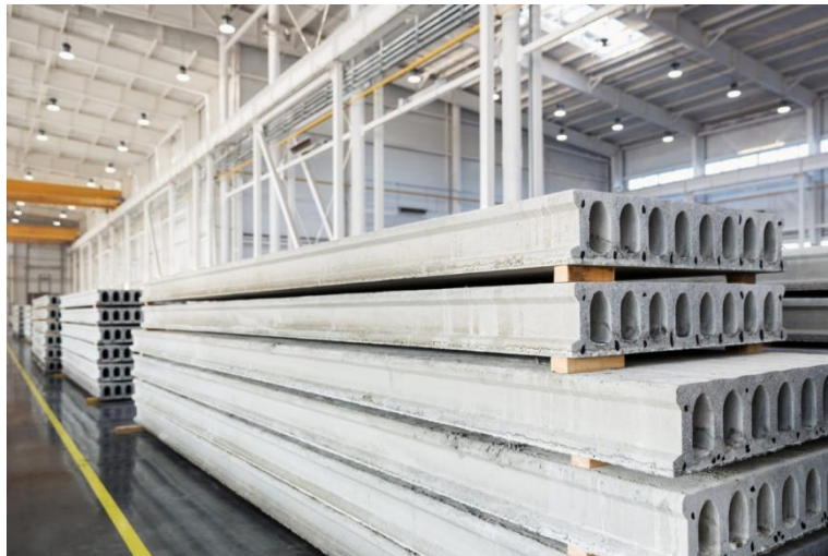
Figura 14. Paneles de Hormigón con polvo de vidrio
