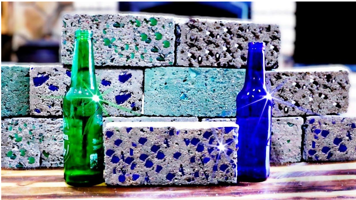
Figura 18. Ladrillos en cemento con vidrio triturado.
