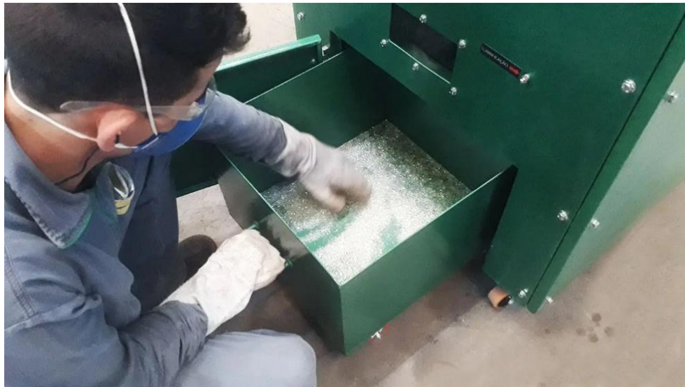
Proceso de triturado del vidrio. (Cristalizando, s.f)
