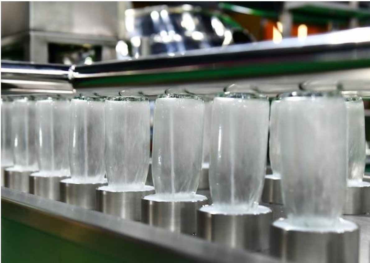
Figura 3. Proceso de limpieza de los envases de vidrio.
