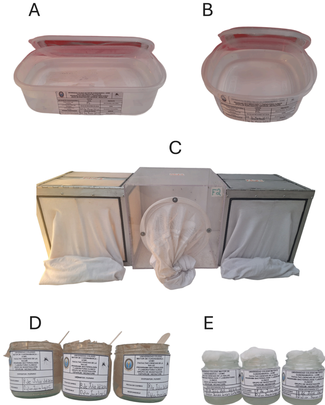
Recipientes empleados en la cría del vector Aedes spp. : A. Cámaras húmedas de huevos con capacidad de 4000 mL, B. Cámara húmeda de larvas con capacidad de 1750 mL, C. Jaulas de cría de aluminio y plástica para adultos con medidas de 30 x 30 x 30 (cm) D. Pupario con capacidad de 450 mL E. Recipiente con capacidad de 110 mL contiene solución azucarada 10% para la alimentación de Aedes spp.
