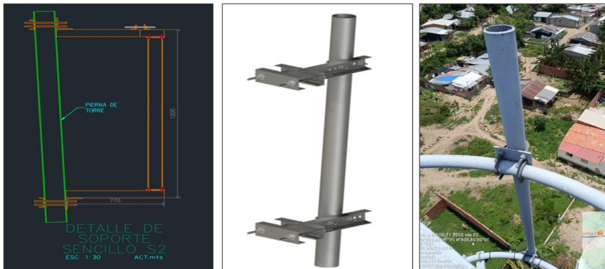
Figura 49. Detalle soporte generador eólico. Autores. Marciales, Mican y Robayo. 2025
