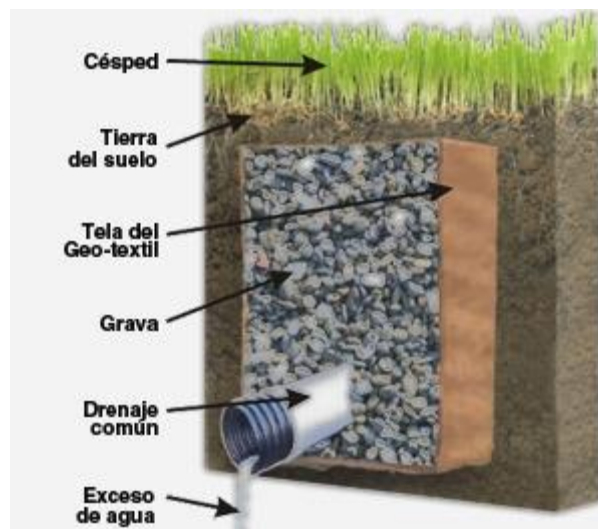
Ilustración 34 Diseño filtro francés Fuente: http://sudsostenible.com/tipologia-de-las-tecnicas/medidas-estructurales/drenes-filtrantes-o-franceses/
