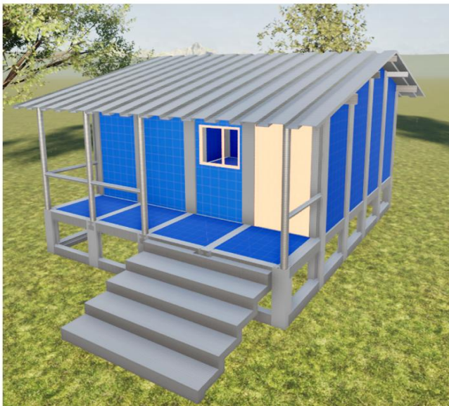
Figura 57 Montaje y ajuste de cubierta sobre viguetas. Elaboración propia.
