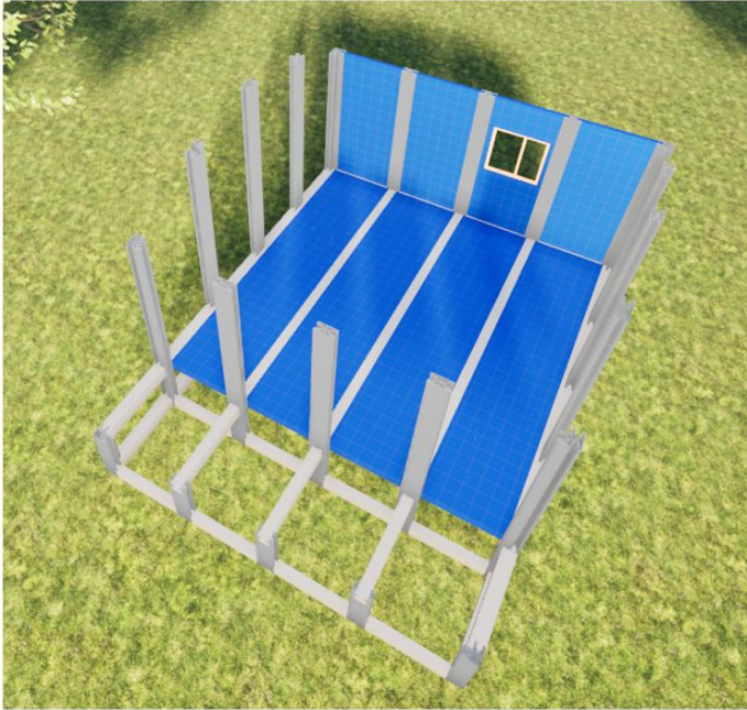
Figura 52 Montaje y ensamblaje de paredes y ventanas Elaboración propia.
