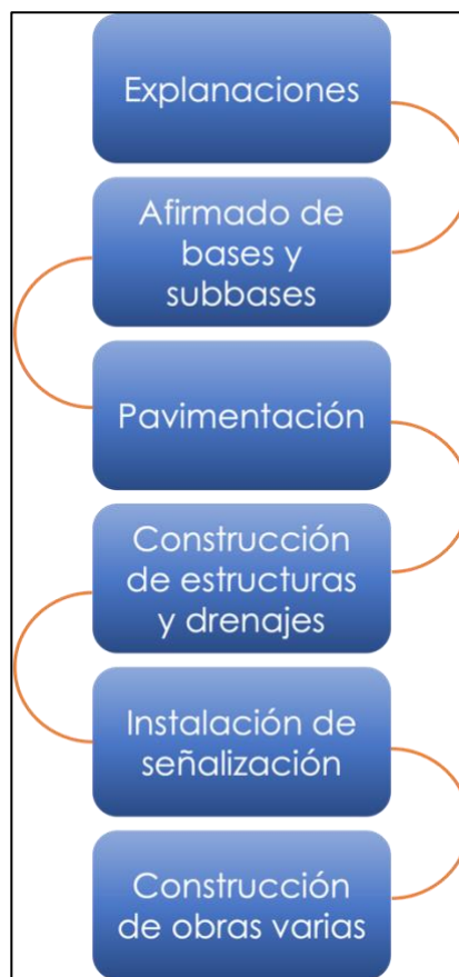
Ilustración 4. Proceso de mejoramiento vial
