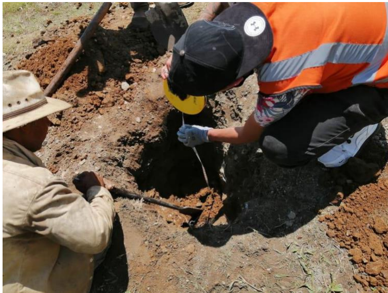
Ilustración 8. Toma de muestras de suelos en los tramos del proyecto de Málaga-Santander Fuente: Alcaldía Municipal de Málaga-Santander
