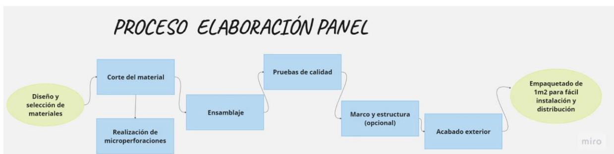
Figura 22. Proceso elaboración panel
